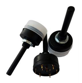
Versione con fascetta metallica di tenuta (anello): eleva la resistenza ad una pressione assiale sull'alberino, dai normali 20 Kg. ad oltre 40 Kg.
